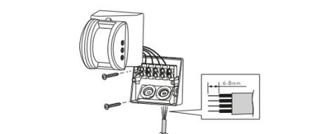
· Fije la base a la pared firmemente mediante los dos tornillos suministrados.
