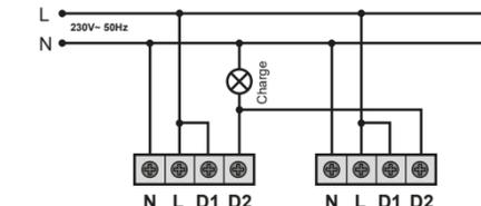
· Installation avec interrupteur pour activer ou désactiver manuellement la détection de mouvement:
