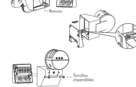
· Ajuste la cabeza del detector en la posición correcta para obtener la cobertura deseada.
