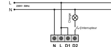
· Installation avec un interrupteur pour allumage permanent:
