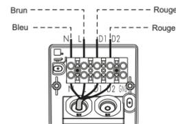
· Installation simple d'un détecteur de mouvement unique:
