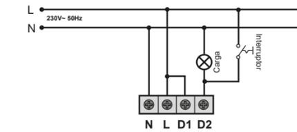
· Instalación con minutero de escalera (p. ej.: MI EL3 003), con la temporización fijada por el minutero (DM TEC 003: 6seg):
