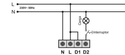
· Instalación con interruptor para encendido permanente:
