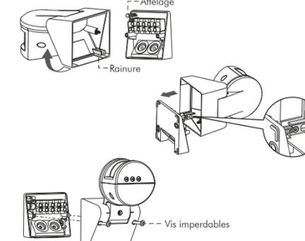
· Réglez la tête du capteur dans la position correcte pour la couverture souhaitée.
