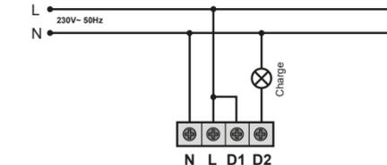
· Installation de deux détecteurs de mouvement en parallèle sur une seule charge:
