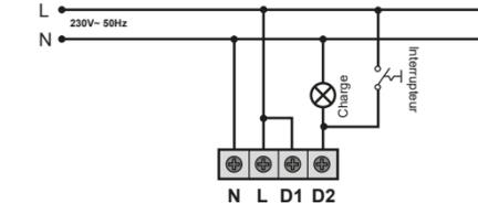
· Installation avec minuterie de l'escalier (par exemple MI EL3 003), avec le temps fixé par la minuterie:
