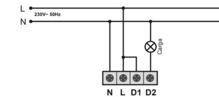
· Instalación de dos detectores de movimiento en paralelo a una sólo carga:
