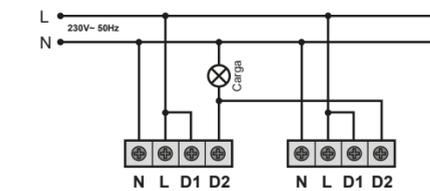
· Instalación con interruptor para activar o desactivar manualmente la detección de movimiento:
