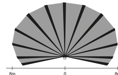
Si el detector es instalado entre 1,8m y 2m del suelo:
