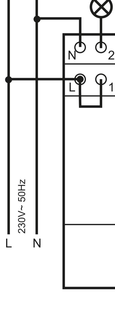
*Nota: es necesario llevar Fase al terminal común del relé para alimentar la carga al ser activado el interruptor. Esto se puede hacer conectando ese terminal a Fase directamente, o realizando un puente con el terminal conectado a Fase (L) para alimentar el interruptor.*
