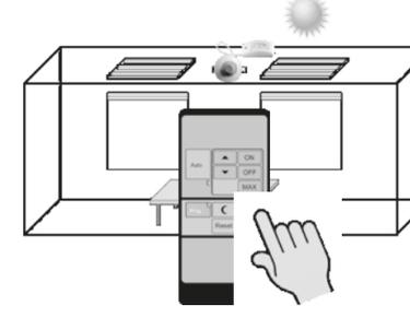
6º - Pulsar la tecla AUTO apuntando al sensor y el RE DMS 004 volverá al modo de funcionamiento normal. Si el aparato no se encuentra en modo TEST (potenciómetro TIME al mínimo) necesitará un tiempo de inercia (de 1 a 4 minutos) hasta alcanzar el nivel de regulación establecido.
