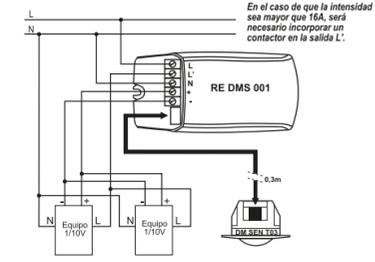
**C.2. Instalación sin emplear el Relé K (salida L')**
