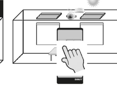
**NOTA:** El RE DMS 001 no permitirá ajustar el punto Día con un nivel de luz natural inferior a la del punto Noche, ni viceversa, no realizando la triple intermitencia de confirmación de punto de luz capturado.
