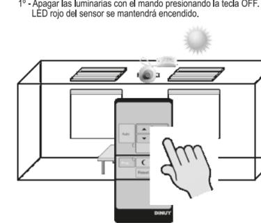
2º - En caso de no ser suficiente el aporte de luz natural, encender las luminarias con la tecla ON y regularlas al nivel requerido para obtener la iluminación deseada en el puesto de trabajo.
