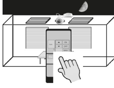
6º - Pulsar la tecla AUTO apuntando al sensor y el RE DMS 001 volverá al modo de funcionamiento normal. Si el aparato no se encuentra en modo TEST (potenciómetro TIME al mínimo) necesitará un tiempo de inercia (de 1 a 4 minutos) hasta alcanzar el nivel de regulación establecido.
