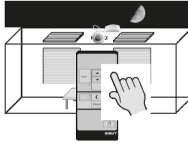
2º - Regular las luminarias al nivel requerido hasta obtener el nivel de luz deseado en el puesto de trabajo. Este nivel será el máximo al que se encenderán las luminarias.
