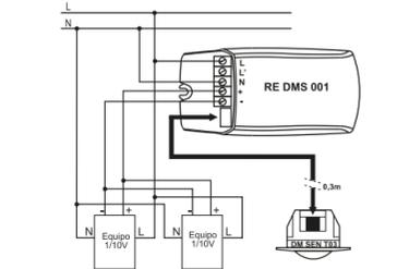
**C.3. Instalación de un interruptor auxiliar para apagado manual**
